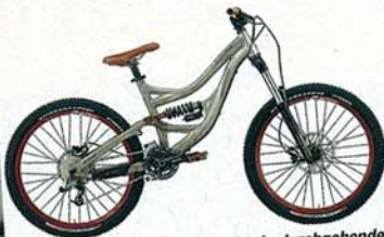
Konisches Steuerrohr (u. 1,5", o. 1 1/8"): mehr Steifigkeit, aber leichter als ein durchgehender 1,5-Standard. Speziell für Specialized deshalb die Domain Gabel mit „Tapered“-Steuerrohr
