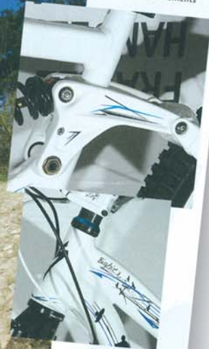
Das Steuerrohr am BigHit verläuft von 1 1/8" auf 1,5" für ein optimiertes Steifigkeits- zu Gewichtsverhältnis
